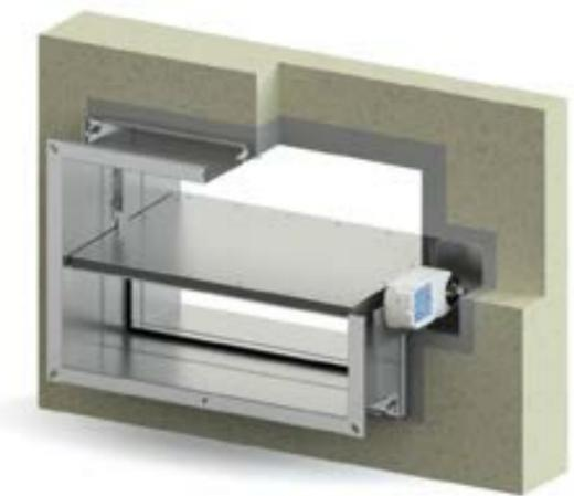
Пример монтажа клапанов OKL-1-120 и OKL-1-180
