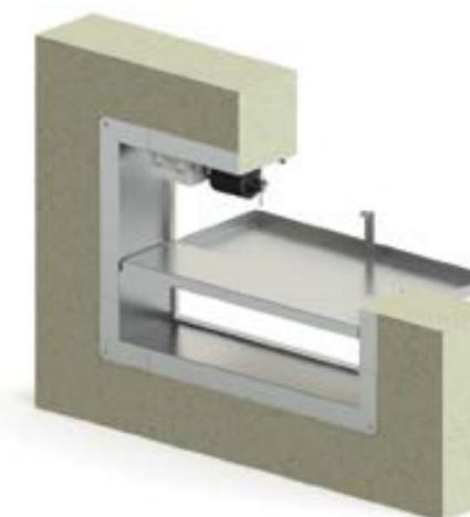
Пример монтажа клапанов OKL-1D-V-S
