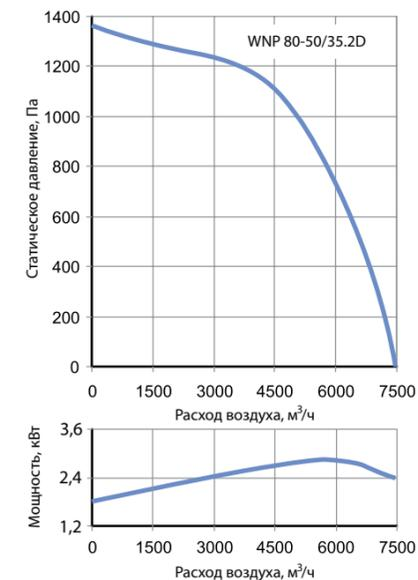
1 — характеристика на номинальных оборотах без использования частотного регулятора (n ном=1410 мин⁻¹)
