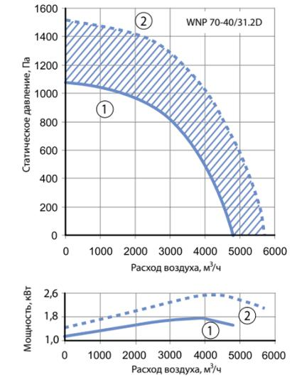
1 — характеристика на номинальных оборотах без использования частотного регулятора (n ном=2840 мин⁻¹)
