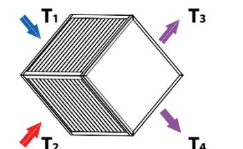
$$\text{КПД} = \frac{T_4 - T_1}{T_2 - T_1}$$
