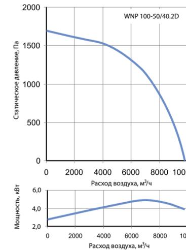
1 — характеристика на номинальных оборотах без использования частотного регулятора (n ном=1435 мин⁻¹)
