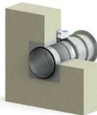
Пример монтажа в стене, нипельное соединение
